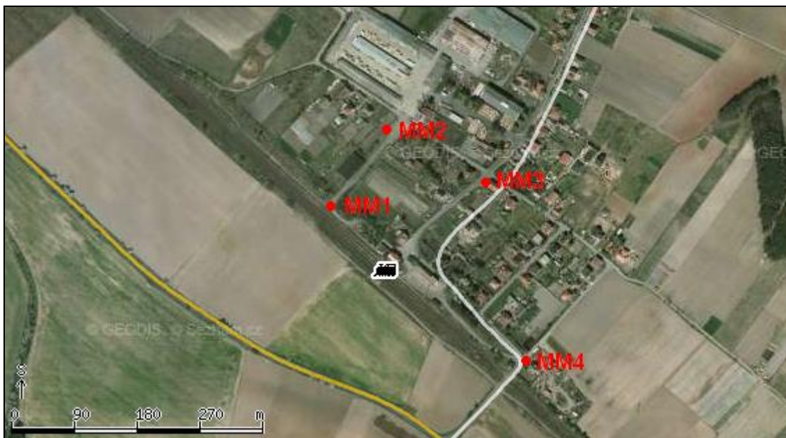
Obr. 5: Rozmístění kontrolních bodů měření hluku.
